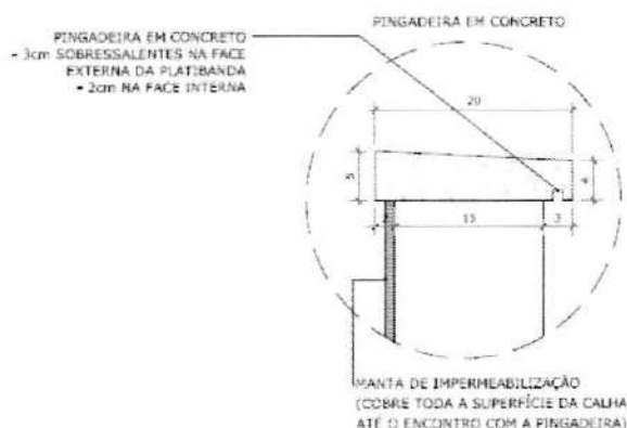
Figura 2 –Detalhamento da pingadeira.
